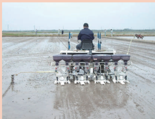
Budidaya dengan penyemaian benih secara langsung ( transplanter serba guna yang dilengkapi penyebar benih)
